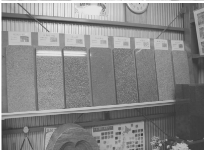
【右・下】展示スペース。岡崎産「牛岩青石」などの国産材もよく出る。下は八寸角の石塔と同じサイズの石種見本（板）
